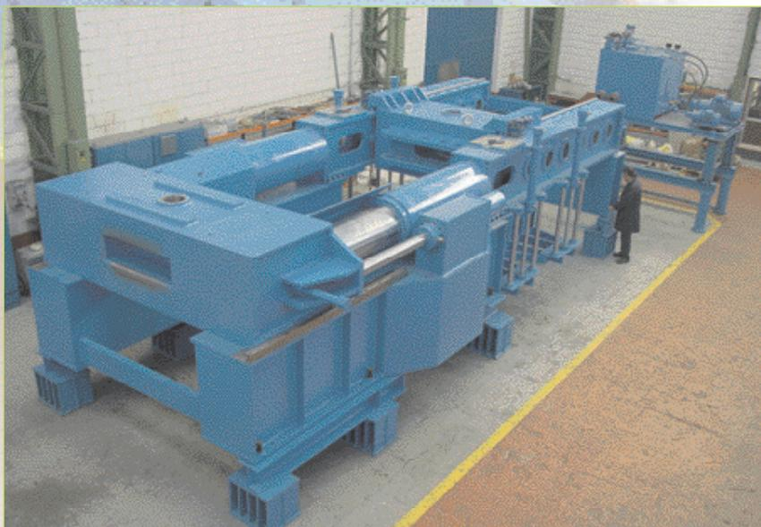
**BANCO DE ENSAYO PARA ACCESORIOS DE ELEVACIÓN**
