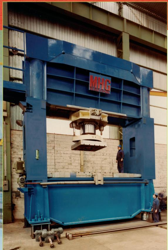
Máquinas de grandes dimensiones y fuerza para doblado/enderezado de chapas y para el conformado de fondos y esferas. Con mesa de trabajo y cabezal desplazables ó fijos.
