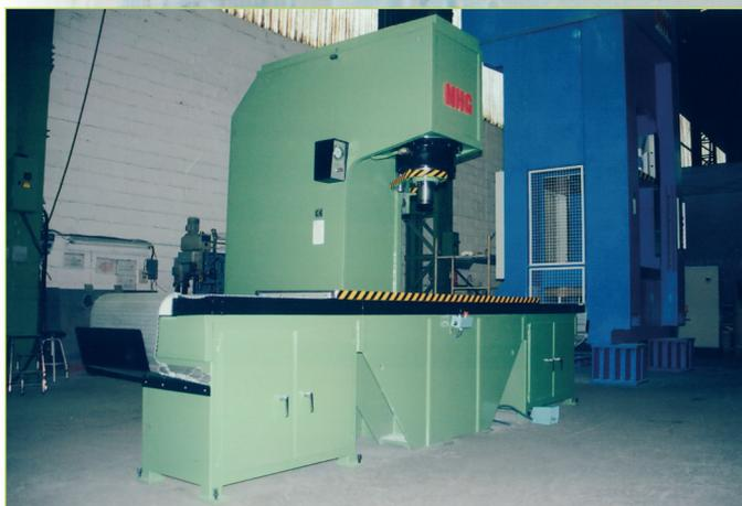
Prensas para enderezado de ejes, puentes de camión, etc. Se construyen con mesa de trabajo desplazable o fija.
